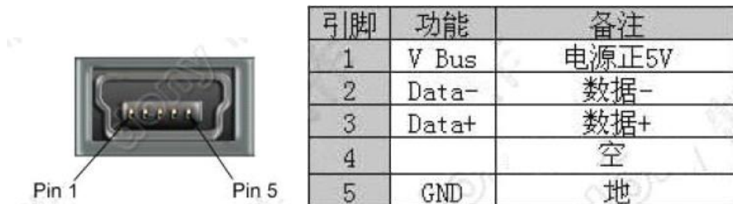
图 2-5 Mini-USB 插座及引脚定义
