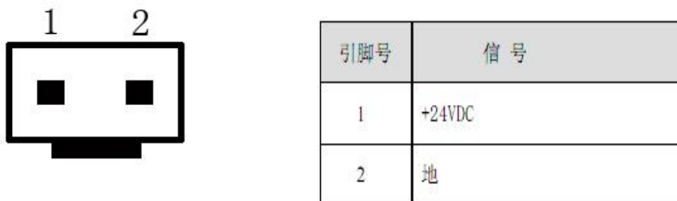
图 2-6 电源插座及引脚定义
