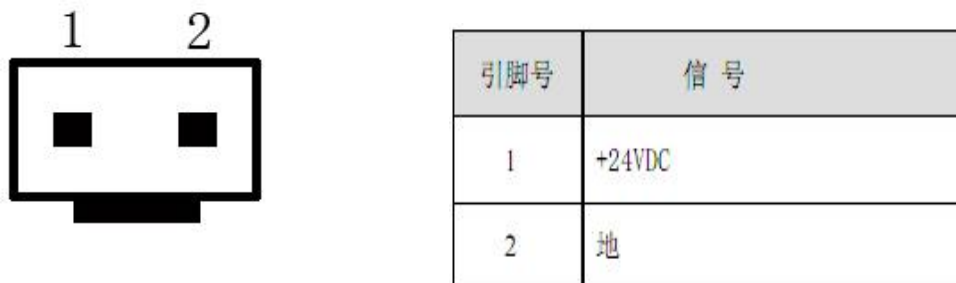
图 2-6 电源插座及引脚定义
