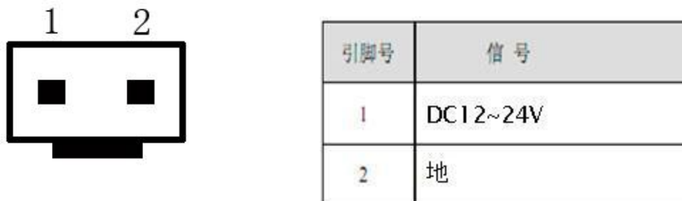
图 2-6 电源插座及引脚定义
