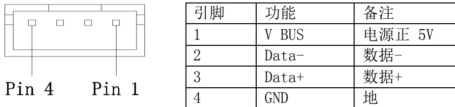
图 2-5 USB 插座及引脚定义
