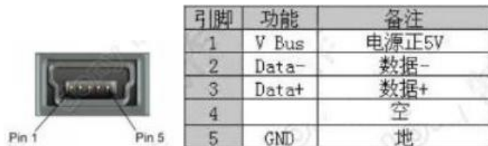
Mini-USB 插座及引脚定义
