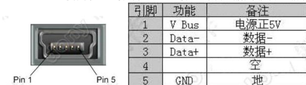
图 2-5 Mini-USB 插座及引脚定义
